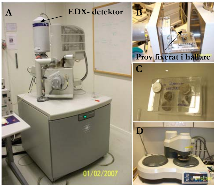
Figur 8. A) Elektronmikroskop, SEM B) Provkammare, öppen C) Epoxiingjutna prov D) Slip och polermaskin för provberedning.
